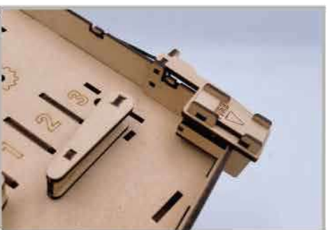
28 彈珠台拉桿頭完成，拉彈數次增加動作流暢度
